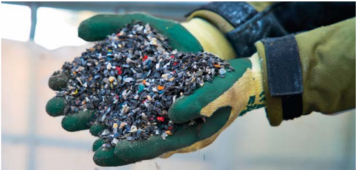
Abbildung 58: Granulierter Plastikabfall in einem Recyclingbetrieb
